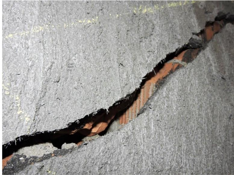
Figura 20. Particolare della lesione diagonale del pannello rinforzato che interessa laterizio e rinforzo.
