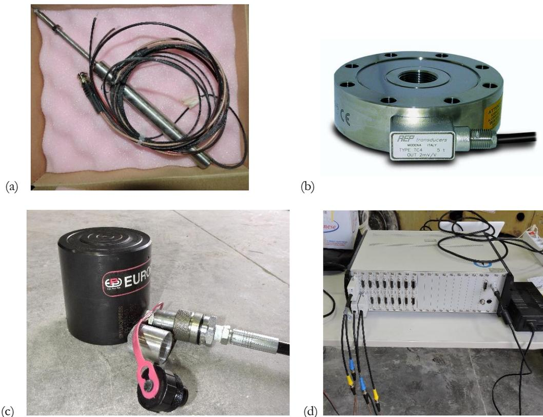
Figura 3. Strumentazione utilizzata per l'esecuzione delle prove: (a) LVDT; (b) Cella di carico; (c) Martinetto idraulico da 30 kN; (d) sistema di acquisizione dati imc CRONOS.
