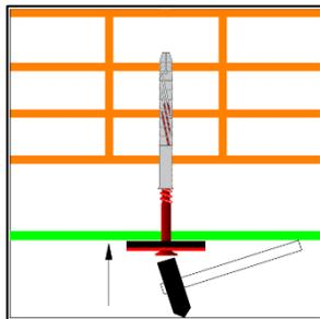
Posizionare il KIT tassello Nylon all'interno del foro e battere pochi colpi sulla testa della vite per inserire completamente la calza in nylon nel foro.
