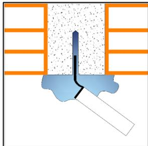
Eeguire la pulizia del foro dalla polvere con aria compressa o equivalente
