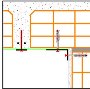
Fissare la Piastra Angolare alla parete divisoria (lato corto) e al solaio (lato lungo) tramite **KIT Tassello Nylon** seguendo le medesime indicazioni descritte nel paragrafo “Applicazione di KIT tassello Nylon (TN)”.
