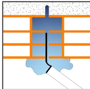
Eseguire la pulizia del foro dalla polvere con aria compressa o equivalente
