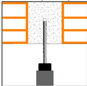
Eeguire il foro di diametro 8 mm e profondità di almeno 80 mm in direzione perpendicolare alla superficie evitando di incrociare le armature del travetto di calcestruzzo
