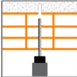
Eseguire il foro di diametro 8 mm attraverso la pignatta fino alla cappa superiore di calcestruzzo con una profondità di almeno 30 mm nel calcestruzzo.
