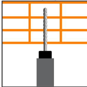
Eeguire il foro di diametro 8 mm e profondità di almeno 100 mm in direzione perpendicolare alla superficie (si suggerisce di utilizzare il tassellatore in modalità “solo rotazione” per evitare il danneggiamento delle pignatte).
