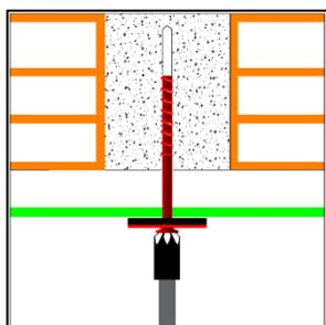
Posizionare **KIT Vite CLS** con rondella nel foro e avvitare fissando la rete all'intradosso del solaio utilizzando un trapano avvitatore o equivalente con inserto TORX T 30.
