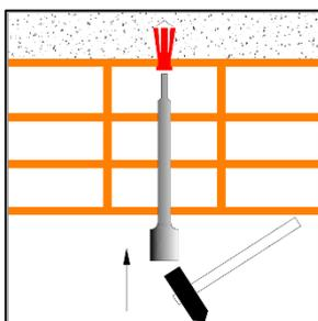
Inserire il tassello a espansione nel foro aiutandosi con la barra filettata per posizionarlo correttamente nel calcestruzzo.
