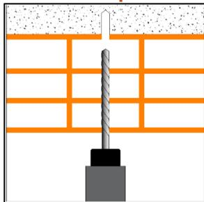
Eeguire il foro di diametro 8 mm attraverso la pignatta fino alla cappa superiore di calcestruzzo con una profondità di almeno 30 mm nel calcestruzzo.
