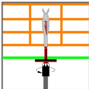
Avvitare la vite con rondella fissando la rete alla pignatta utilizzando un trapano avvitatore o equivalente con inserto TORX T 30.
