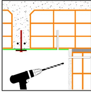
Eeguire un foro di diametro 8mm e profondità 100mm nella direzione perpendicolare alla superficie della parete divisoria e del solaio.
