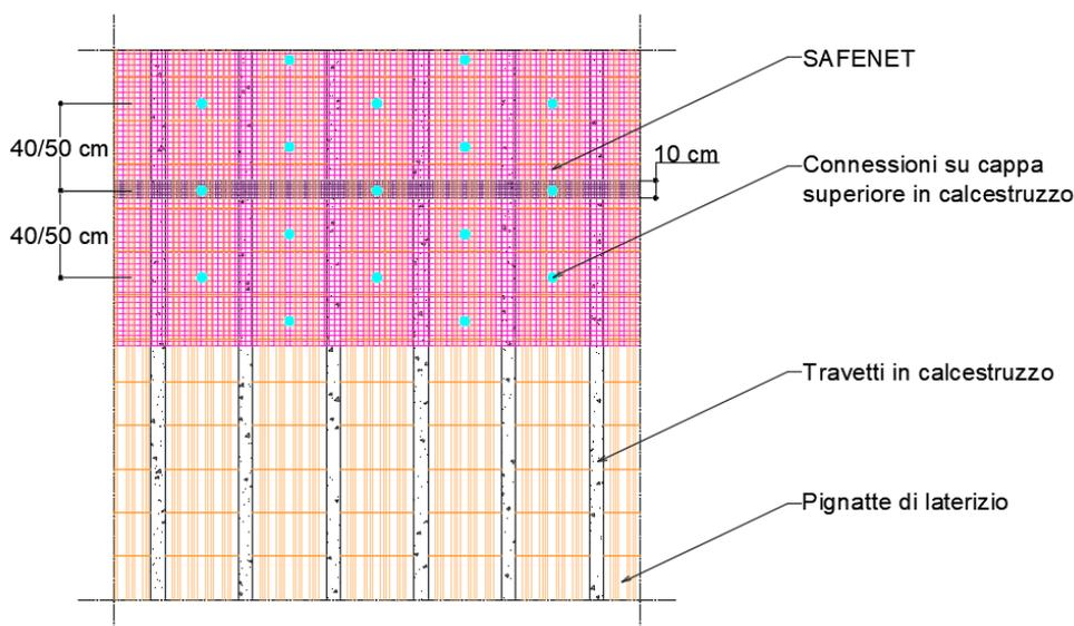
La rete **SafeNet** viene applicata in direzione perpendicolare all'orditura del solaio garantendo il **sormento di almeno 4 maglie (10 cm)** della rete in entrambe le direzioni.
