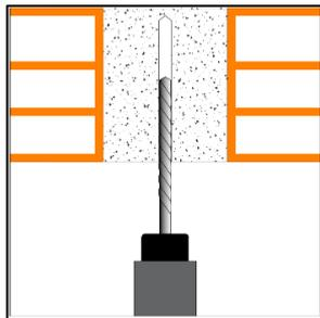
Eeguire il foro di diametro 6 mm e profondità di almeno 100 mm in direzione perpendicolare alla superficie evitando di incrociare le armature del travetto di calcestruzzo.
