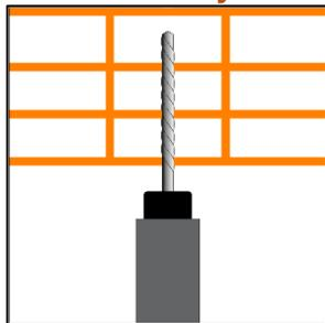
Eseguire il foro di diametro 8 mm e profondità di almeno 100 mm in direzione perpendicolare alla superficie (si suggerisce di utilizzare il tassellatore in modalità “solo rotazione” per evitare il danneggiamento delle pignatte).
