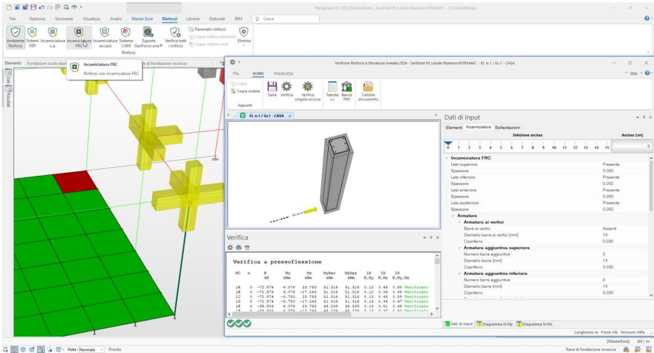
In Verifiche Rinforzi, per il dimensionamento delle incamiciature con sistemi FRC, si adottano le indicazioni e i principi di verifica del **CNR-DT 204** in cui vengono definiti e illustrati anche i parametri meccanici e geometrici finalizzati alla descrizione del sistema FRC come rinforzo di un elemento strutturale in c.a.
