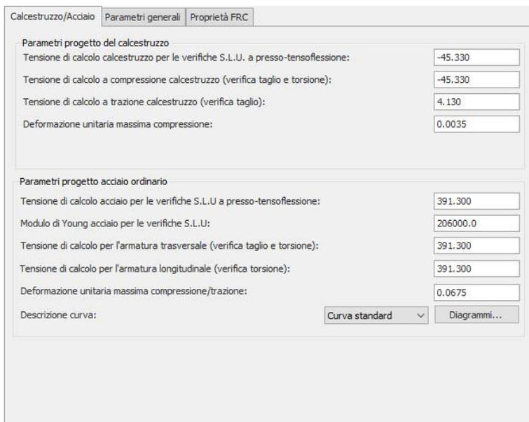
Figura 6 - Caratteristiche di resistenza del cls C80/95
