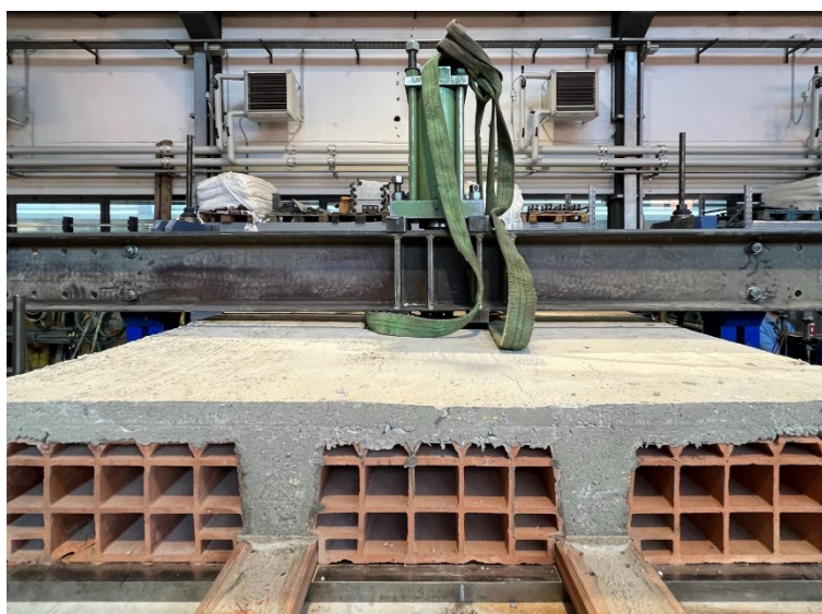
Figura 9. Dettaglio della sezione del solaio.
