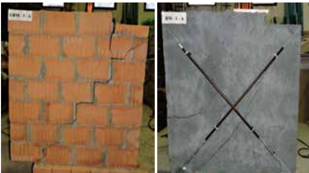
Modalità di rottura dei test a compressione diagonale di pannelli murari (a sx pannello non rinforzato, a dx pannello rinforzato con MX-PVA Fibrorinforzata) | Report Università degli studi di Perugia.
