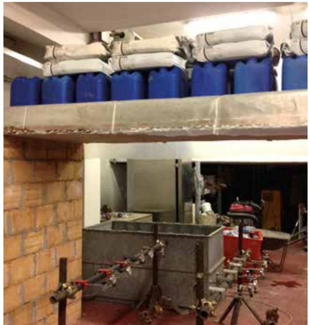
Prove di carico sistema STUCANET.
