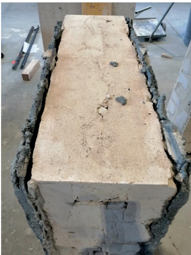
**Gli interventi di rinforzo con MX-PVA Fibrorinforzata hanno permesso di incrementare la resistenza del provino con un coefficiente** (rapporto tra il carico ottenuto nella configurazione rinforzata e quello nella configurazione non rinforzata) **compreso tra 2.26 e 4.71.**
